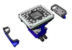
8. 安装散热器(请参阅 "散热器安装说明")。
